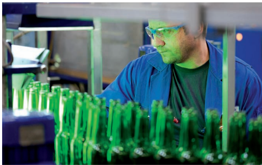
Produktion bei Vetropack: Jede Glasflasche wird optisch, mechanisch und elektronisch geprüft. Was nicht Mass hält, wird in den Schmelzöfen zurückgeführt.
