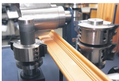
Ein Werkzeug von Oertli, mit dem ein Rahmenprofil aus Holz hergestellt wird
