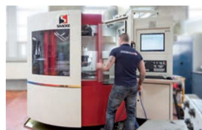
Die CNC-Schleifmaschine von Oertli kennt keinen Feierabend. Rund um die Uhr bearbeitet sie Präzisions-Schaftwerkzeuge – auch übers Wochenende.
