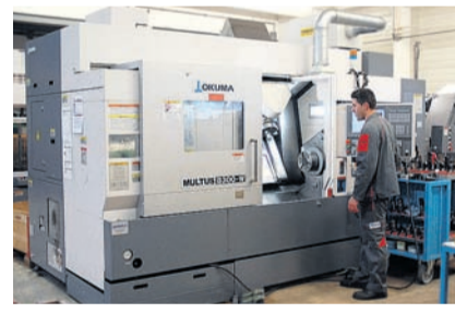
Ein Polymechaniker bedient ein CNC Drehfräszentrum bei Stutz Mechanik AG
