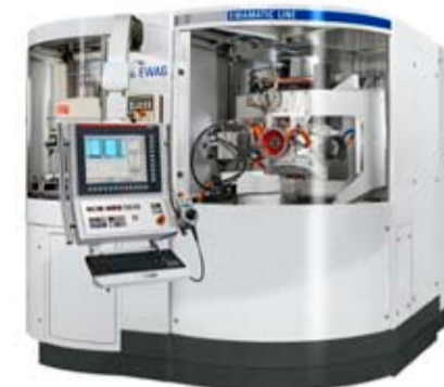
Schleifcenter Ewamatic zum Schleifen von Wendeplatten
